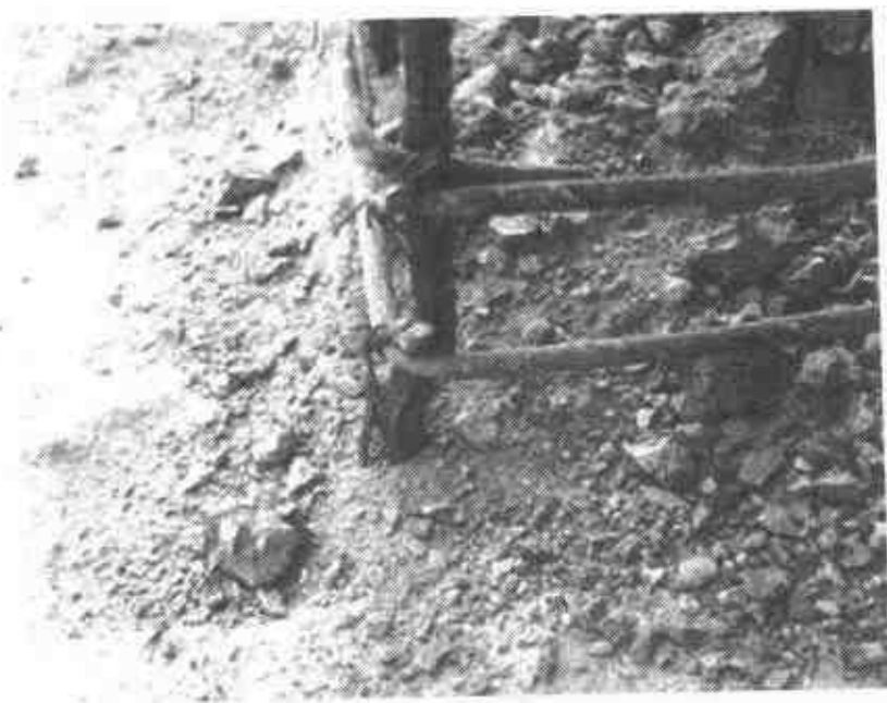
a) 6号试件纵向钢筋压曲
