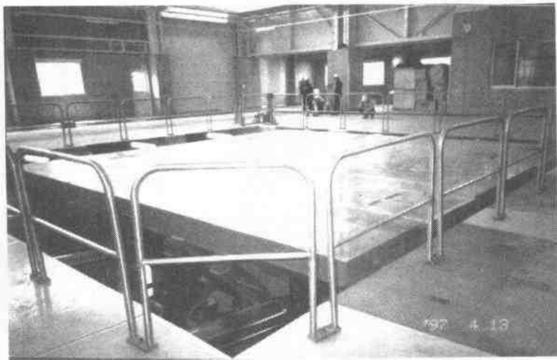
图 4.5 大型模拟地震振动台
