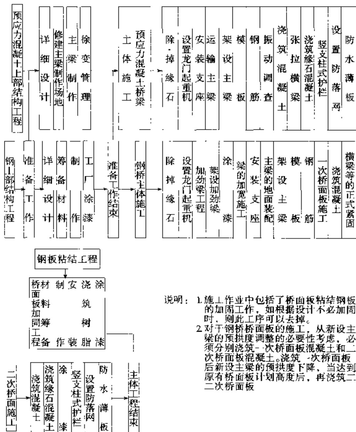
预应力混凝土桥与钢桥上部结构加宽作业顺序图 表 4-6
