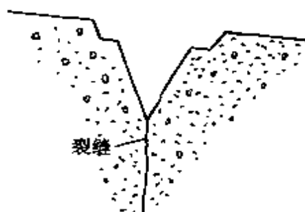
图 3-33 台阶“V”形槽示意图
