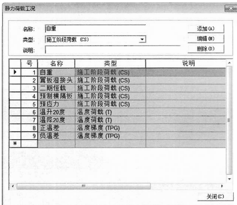
图 2-13 定义成桥荷载工况
