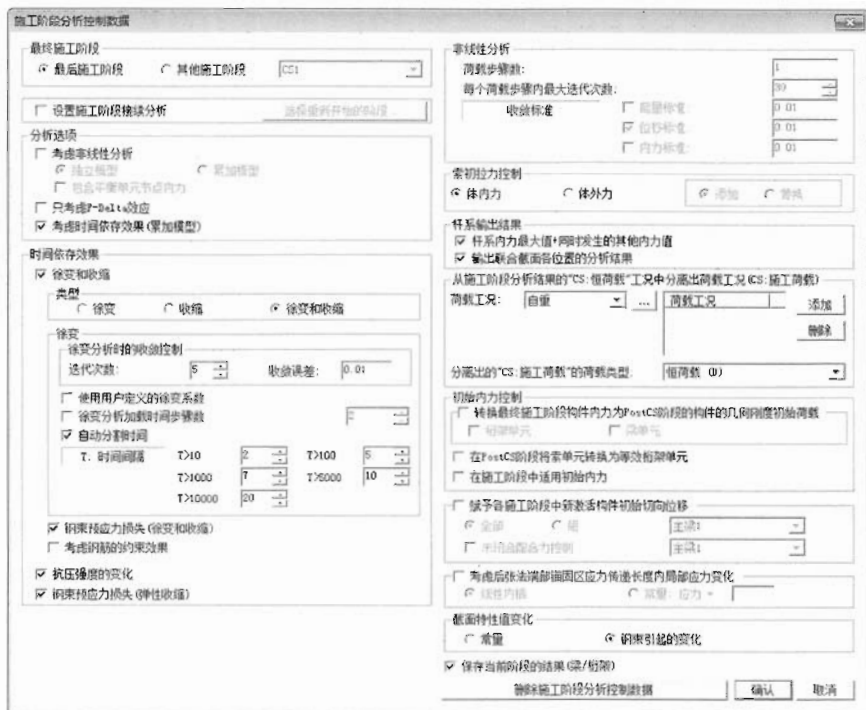
图 1-21 定义施工阶段分析控制数据
