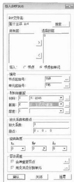
图 6-10 导入 AutoCAD 图形进行建模
