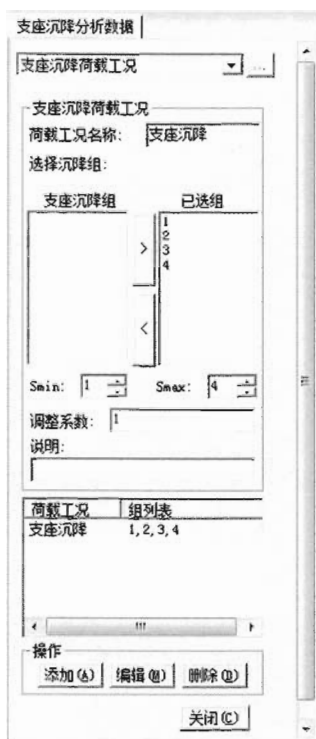
图 7-15 支座沉降荷载工况定义
