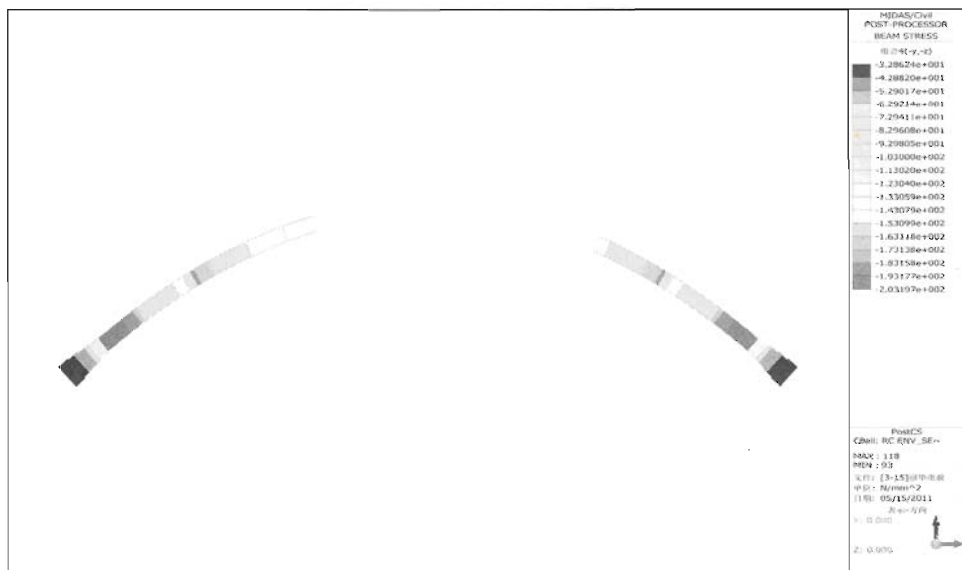
图 12-22 主拱肋弹性阶段荷载效应组合下缘应力分布(MPa)
