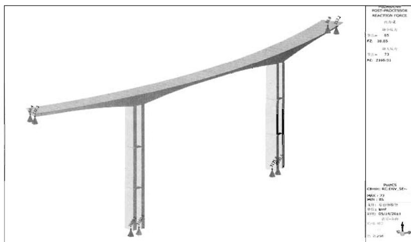
图 9-11 运营阶段支座最小反力图(最小:40t)
