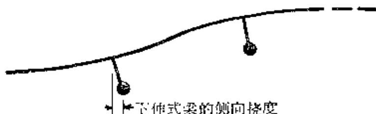
图7.8 下伸式梁格的部分截面表示着由于横向弯曲对纵向梁的侧向挠度
