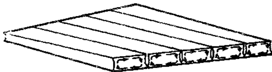
图6.8 剪力铰桥面上部结构梁内的扭转剪力流
