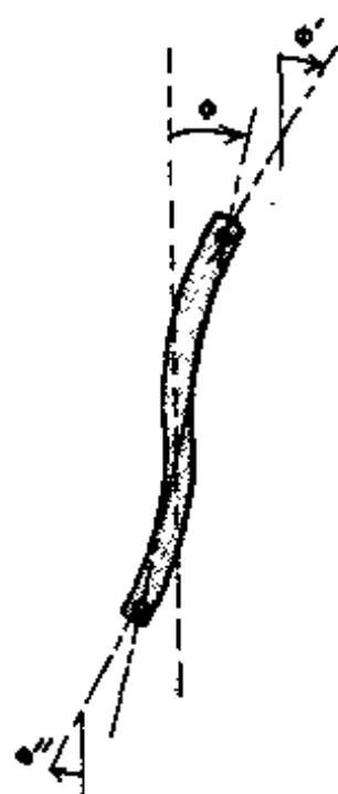
图B.11 薄腹板平面外弯曲
