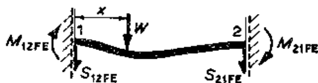
图 2.10 固端弯矩和剪力
