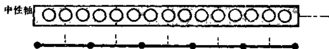
图3.14 空心板式上部结构纵向梁格构件的布置
