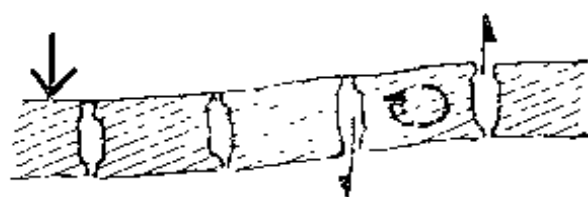
图1.9 剪力铰接桥面中由梁的扭矩来抵抗梁的不同挠度
