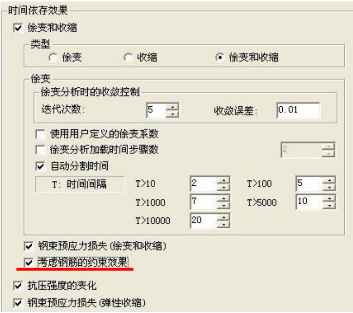
图 5.11.1 设置普通钢筋对收缩徐变的影响
