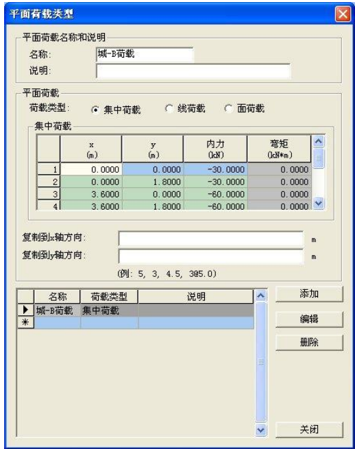
图 4.6.2 用平面荷载模拟城-B 荷载
