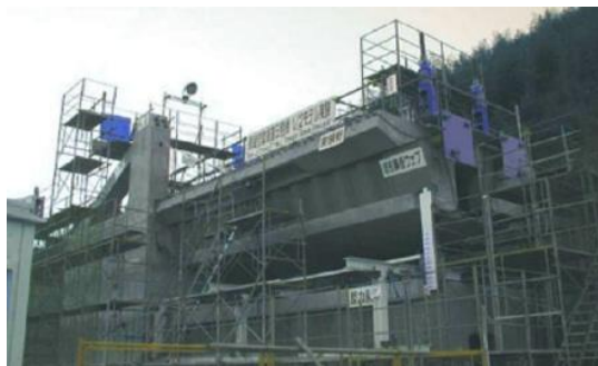
图 5-155 1/2 实体模型试验
