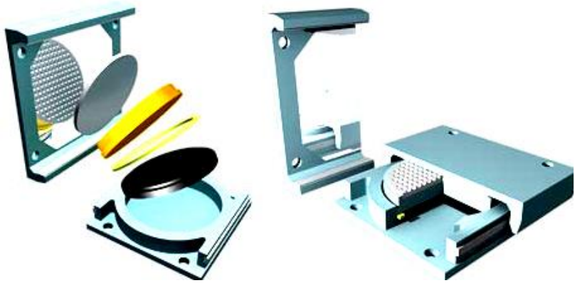
图 2-87 盆式橡胶支座结构图
