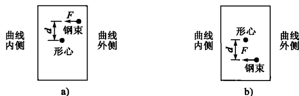
图 4-41 预应力作用示意图
