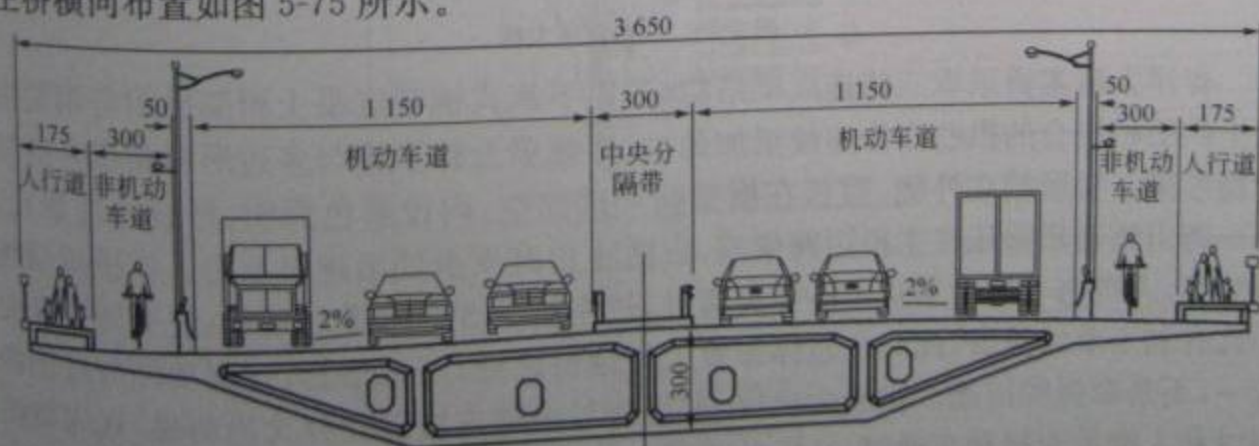
图 5-75 主桥横向布置 (尺寸单位:m)
