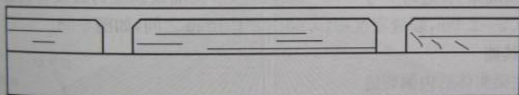
图 8-59 实体肋内侧裂缝
