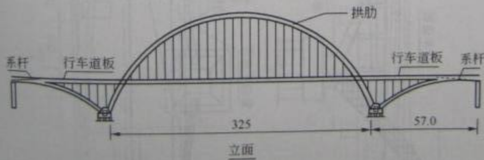
图 8-50 江苏某主跨 325m 桥飞鸟型中承式系杆拱 (尺寸单位:m)
