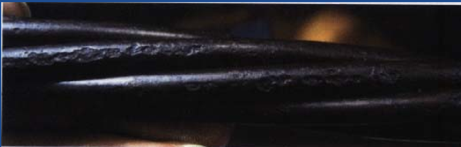
钢绞线不均匀分布的局部腐蚀（坑蚀）
