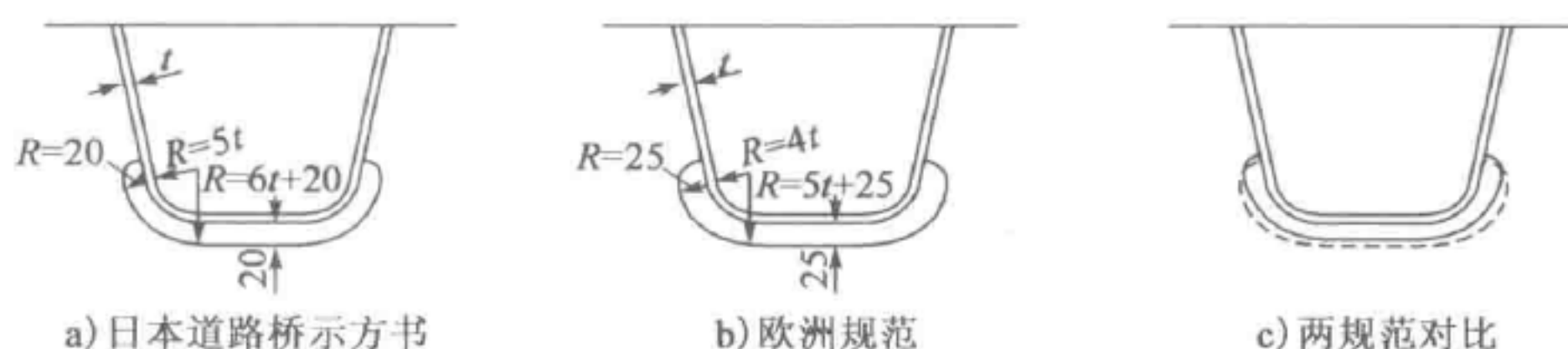
图 6-33 日本规范给出的弧形缺口细节及其与欧洲规范的对比(尺寸单位: mm)
