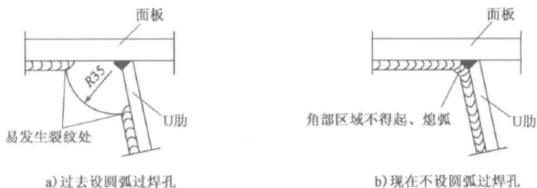
图 6-29 横肋在面板与纵肋角焊缝处过焊孔的改进
