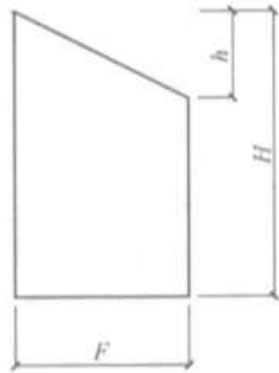
图 C.0.5 混凝土侧压力计算分布图
