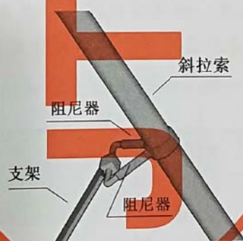
图 9-5 斜拉桥阻尼器安装示意图
