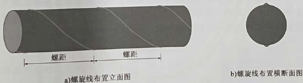
图 9-8 附加螺旋线的布置示意图
