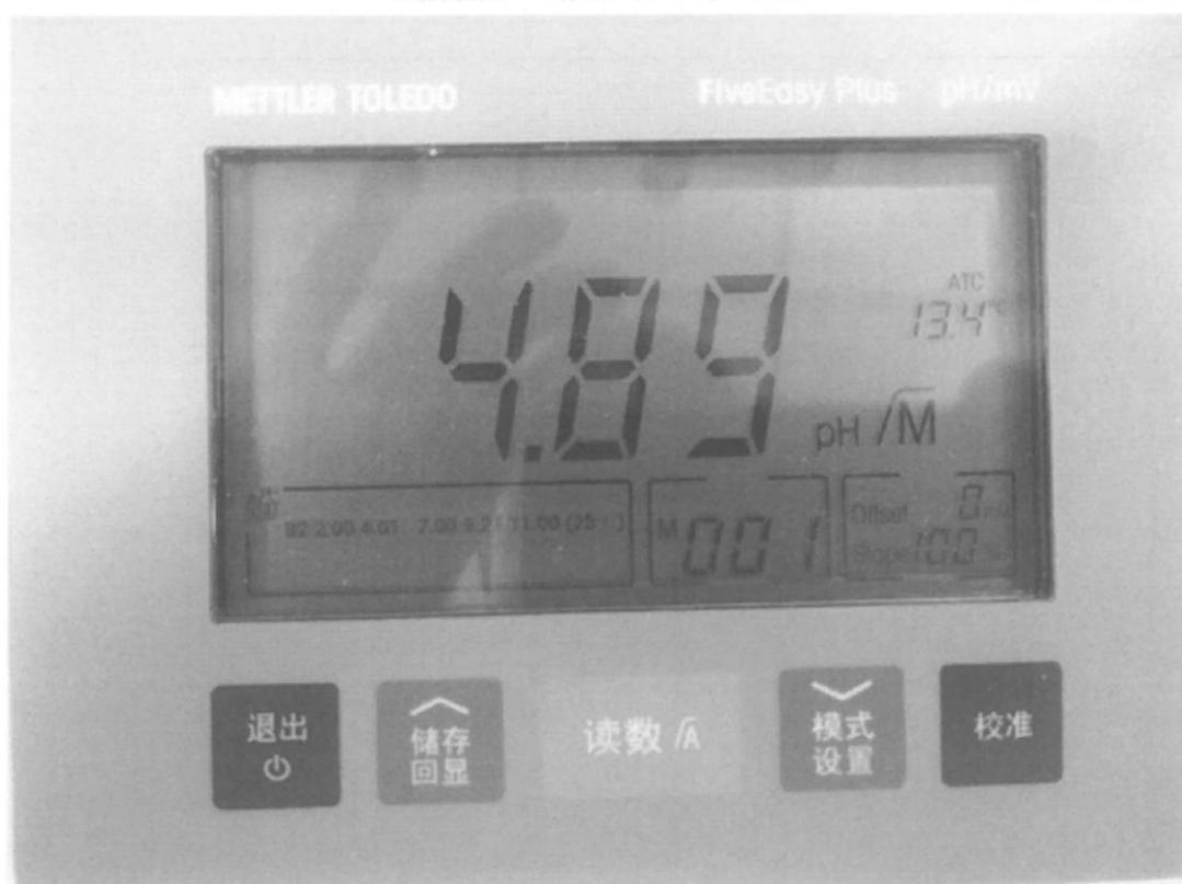
6. 设备支持5点校准，并有线性校准和线段校准两种模式，具有4组预设缓冲液组线性/线段校准模式，lin为线性校准，Seg为线段校准
