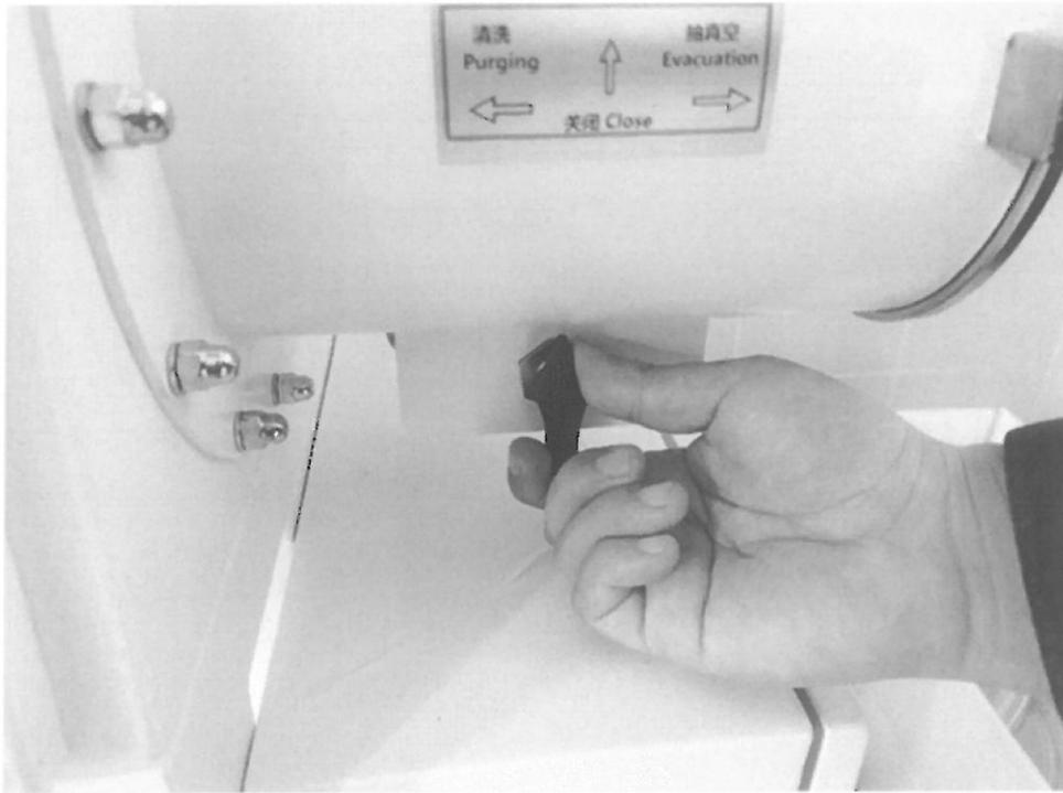
测试过程：开启真空泵，将大仓和小仓进行放气，此时压力由-0.05bar 到达 0bar，然后打开舱门，放入物品，关闭舱门，大仓和小仓重复抽气和放气三次，直到空气排出，此时舱内压力与手套箱内压力保持一致，为-0.05，从手套箱内部打开舱门，取出物品，然后进行补气，经过 10 秒，过渡仓和小仓压力达到-0.05bar。取放物品的整个过程中，箱体内水含量总体保持稳定，小于 1ppm，氧气含量由 0.33ppm 增加到 0.66ppm，然后又经过三次抽放气 4 分钟左右达到 0.33ppm。
