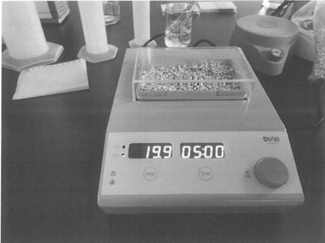
测试过程：温度设定界面将温度设定为 105℃，过了 18 分钟左右，设备达到了设定温度 105℃
