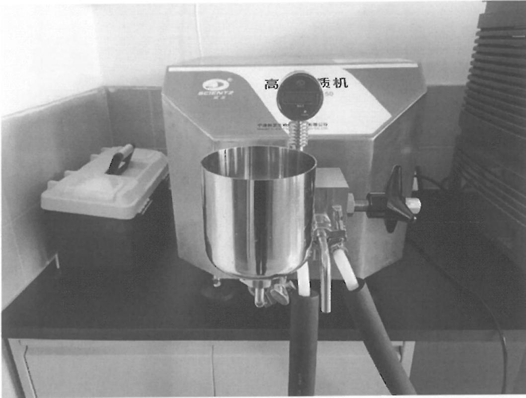
2. 将设备主机和冷却循环水机进行通电测试，发现运行良好（主机没有数显屏幕，肉眼只能看到低温冷却循环水机运行界面）
