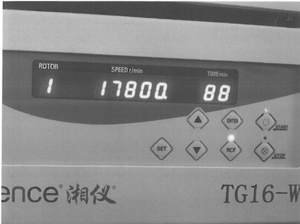
2. 设备转速精度为 $\pm 30\text{rpm}$ ，定时范围为 1-99min
