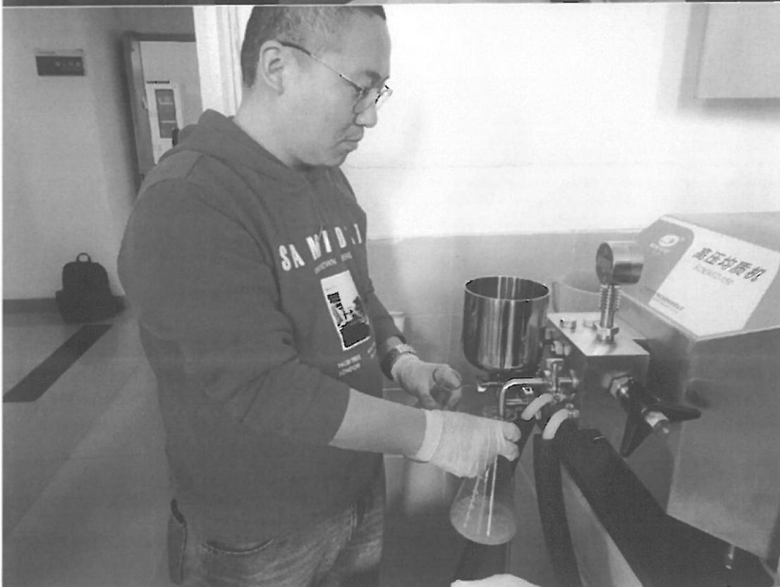
测试结果: 经过一分钟左右, 大肠杆菌培养液在 680bar 的压力处理下, 由于细胞破碎产生了沉淀, 培养液由浑浊变得透亮, 颜色由浊白偏黄色变得偏黑色。
