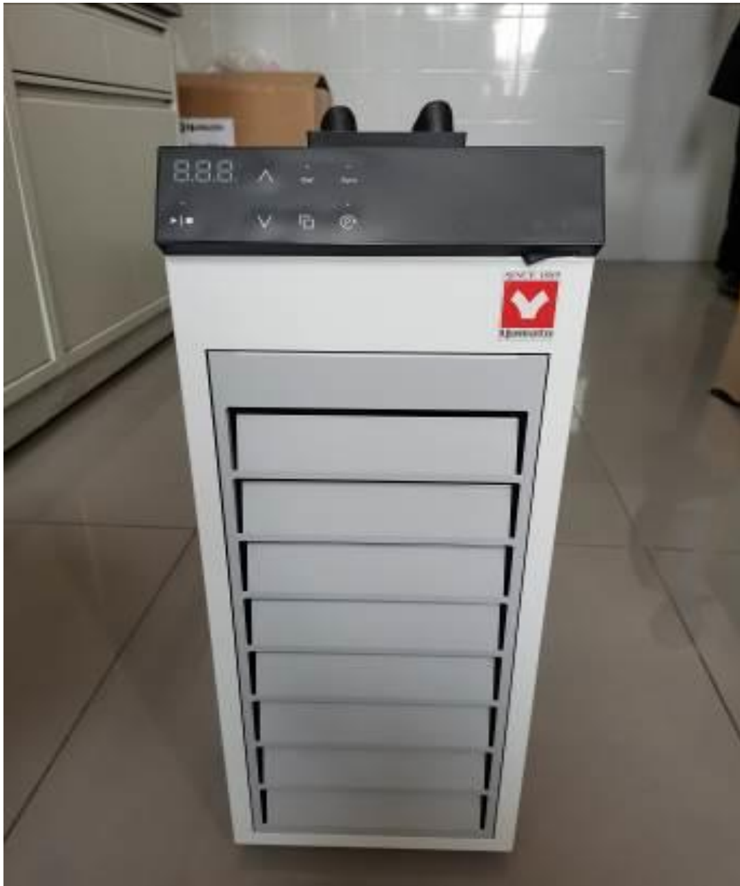
循环冷凝泵 CF312L-B
