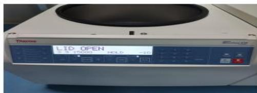
可以根据需求设置转速，时间，温度，以此来控制离心
