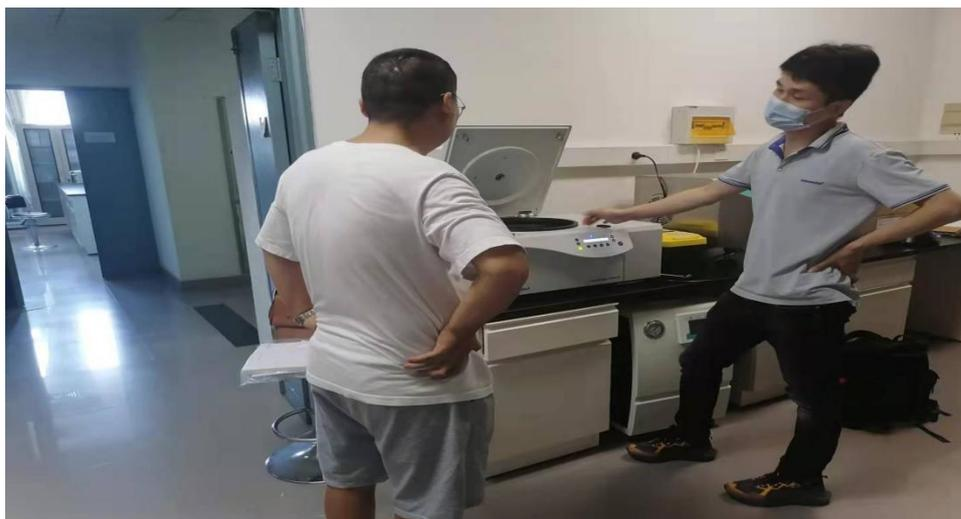
7、台式高速冷冻离心机品牌型号：Thermo fisher Multifuge X1R 产地：德国
