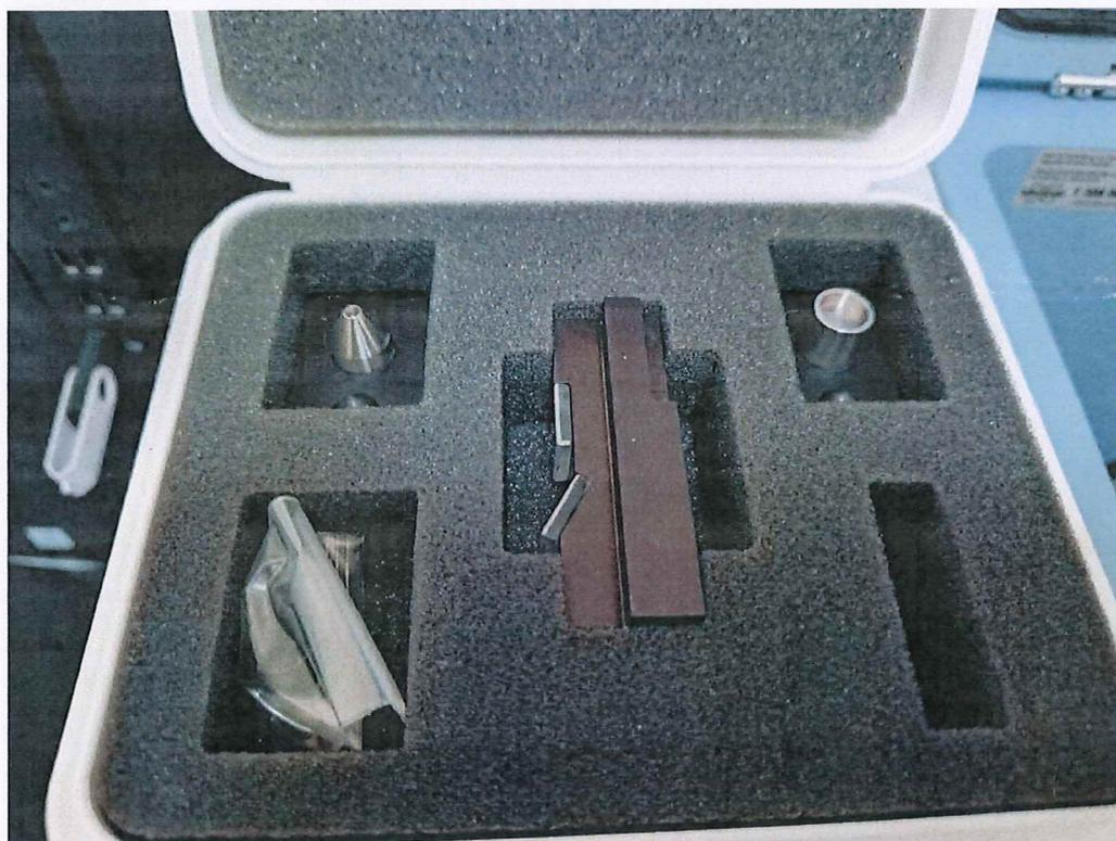
21. 漫反射高温原位反应池(不包括上盖及窗片), 真空下可升温度 910°C。
